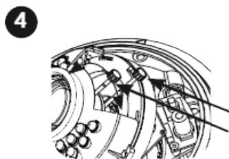
a) Ôter le couvercle de la caméra en pressant simultanément l'avant et l'arrière du couvercle (à l'endroit où il est indiqué «PRESS»)
