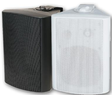
Cette gamme d'enceintes 2 voies de 30W est équipée d'un boomer de 5 pouces et d'un tweeter. Elle est fabriquée en ABS avec une grille métallique à peinture époxy.
