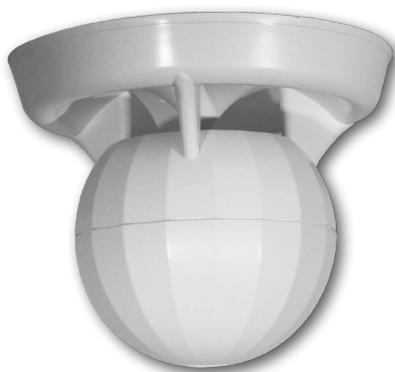
La SP3830T est une enceinte sphérique qui peut être fixée au plafond ou suspendue par câble. Cette enceinte deux voies est équipée d'un boomer 8" et d'un moteur 1". Sa dispersion sur 360° et sa couverture vous permettront de réaliser des installations très homogènes et de minimiser le nombre de haut-parleurs nécessaires pour couvrir la surface donnée.
