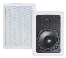
Cette gamme d'enceintes 2 voies de 20W, est équipée d'un boomer de 5" et d'un tweeter 1" Mylar. Elle est fabriquée en ABS avec une grille métallique à peinture époxy. Elle peut être alimentée en ligne 100V ou basse impédance. Utilisation en intérieur.
