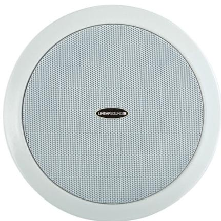
Le PL249 est un haut-parleur de plafond monté avec un transformateur 70V / 100 V. Ce dernier réduit les pertes en ligne sur les longues distances et permet une connexion parallèle de haut-parleurs multiples.
