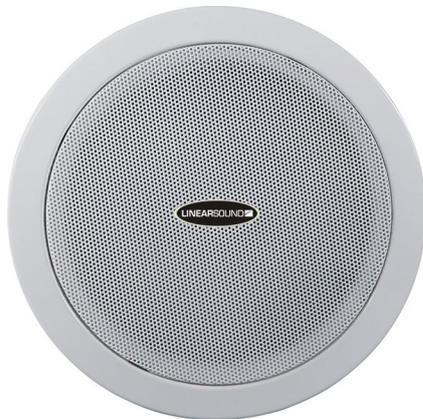
Le PL166CF est un haut-parleur de plafond anti-feu fourni avec un transformateur de 70 V / 100 V. Ce dernier réduit les pertes en ligne sur les longues distances et permet une connexion parallèle de haut-parleurs multiples.
