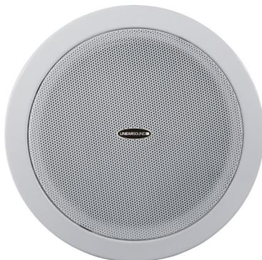
Le PL2415CF est un haut-parleur de plafond anti-feu fourni avec un transformateur de 70 V / 100 V. Ce dernier réduit les pertes en ligne sur les longues distances et permet une connexion parallèle de haut-parleurs multiples.
