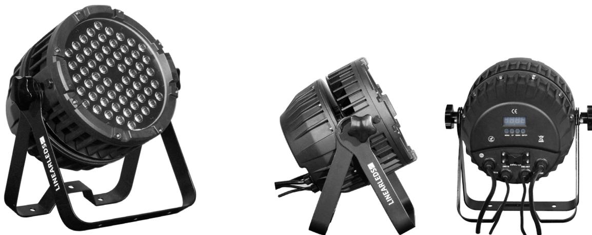
Le SUNFLOWER est un projecteur LED 48 x 3W, RGBW, étanche. Il dispose d'une répartition chromatique équitable et permet de nombreux effets : dimmer 0-100%, strobe, changement de couleurs, vitesse réglable... Il est pilotable en DMX512, auto run, maître / esclave, 8 canaux.
