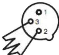
Connecteurs 3 broches et 5 broches : Si le contrôleur DMX512 est en 5 broches, utiliser un câble signal qui transfère le 5 broches en 3 broches.
