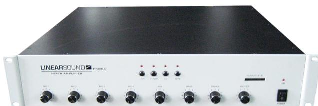
Cet ampli - préampli dispose de 4 sorties (50V - 70V ou 4-16 $\Omega$ ) , de 4 entrées micro avec alimentation fantôme et priorités et 4 entrées double RCA avec ligne commutable.
