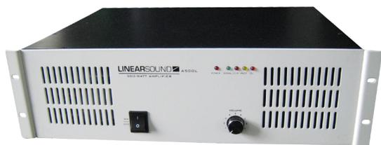
Cet amplificateur propose quatre sorties 50V, 70V, 100V et 4-16 Ohms. Cette gamme dispose d'une entrée et sortie symétrique (connecteurs XLR) et/ou asymétrique (connecteurs jack 6.35), de voyants et du contrôle du volume. Le A500L est totalement protégé contre les courts circuits, la surtension, et est équipé d'une ventilation silencieuse asservie.
