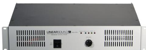
Cet amplificateur propose 4 sorties 50V, 70V, 100V et 4-16 ohm. Cette gamme dispose d'une entrée et sortie symétrique (connecteurs XLR) et / ou asymétrique (connecteurs jack 6.35), de voyants et du contrôle du volume. Le A240L est totalement protégé contre les courts circuits, la surtension et est équipé d'une ventilation silencieuse asservie.
