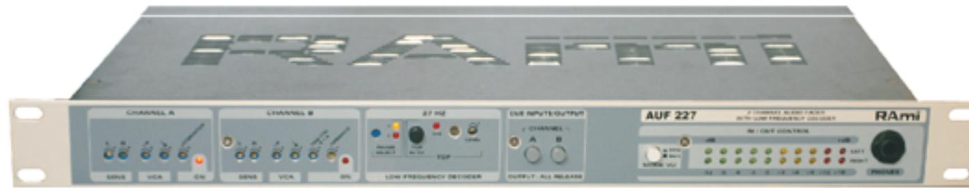
L'AUF 227 est identique à l'AUF 200, avec un décodeur 27 Hz intégré. Sur cet appareil, le passage d'un canal à l'autre peut s'effectuer, soit sur la présence de la modulation sur le canal B, soit sur l'envoi d'un 27 Hz présent dans la modulation du canal B, soit sur une combinaison des deux. La commutation par une boucle extérieure est aussi possible.
