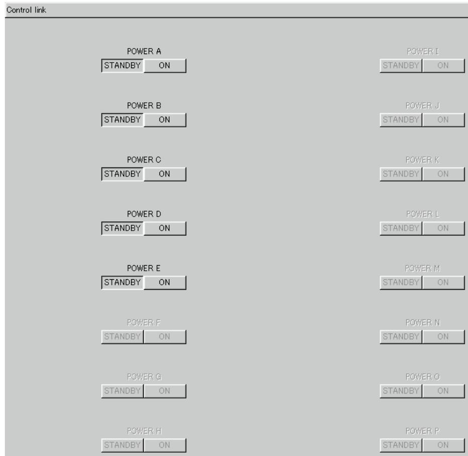
Les boutons STANDBY et ON ne sont pas actifs si le groupe en question ne contient pas d'amplificateur de puissance ou si le groupe est désactivé. Quand un groupe est actif, vous pouvez cliquer sur son bouton STANDBY pour mettre simultanément tous les amplificateurs de puissance de ce groupe en mode Standby. Vous pouvez cliquer sur un bouton ON pour mettre sous tension tous les amplificateurs contenus dans ce groupe.
