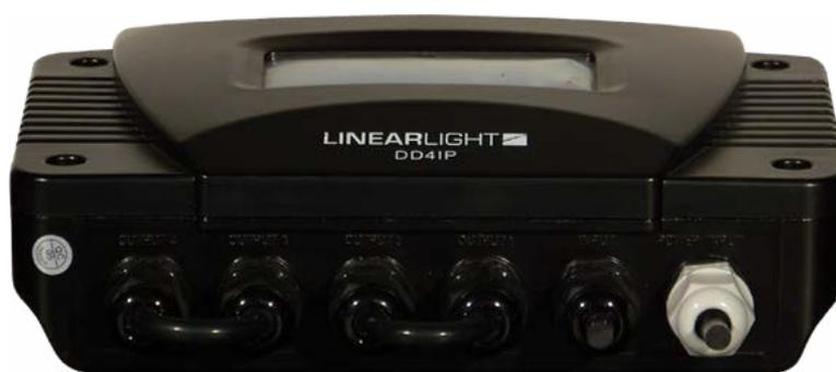
Ce distributeur DMX s'accorde avec n'importe quel contrôleur DMX512 et appareil d'éclairage qui a un signal DMX. Le DD4IP est équipé d'une fonction test de signal DMX512. Il dispose d'une entrée signal DMX et de 4 sorties avec système d'amplificateur de signal séparé. Chaque sortie a un presse étoupe PG9 waterproof.
