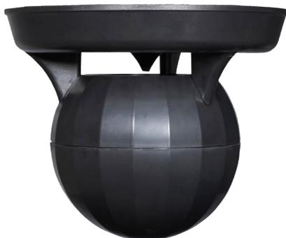
Le SP3860B est un haut-parleur à suspendre fourni avec un transformateur de 70V / 100V. Ce dernier réduit les pertes sur les longues distances et permet une connexion parallèle de haut-parleurs multiples.
