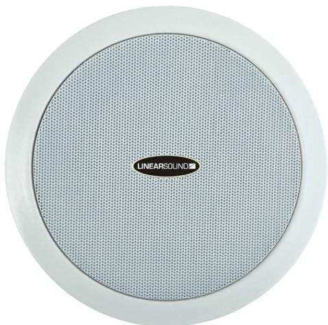
Le PL206A est un haut-parleur de plafond fourni avec un transformateur de 70V / 100V. Ce dernier réduit les pertes en ligne sur les longues distances et permet une connexion parallèle de haut-parleurs multiples.
