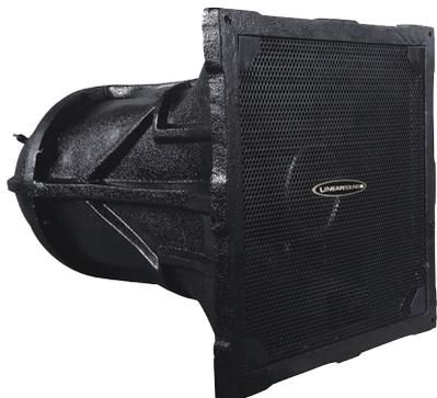
Le PDS150 est un haut-parleur étanche monté avec un transformateur 70 V / 100 V. Ce dernier réduit les pertes en ligne sur les longues distances et permet une connexion parallèle de haut-parleurs multiples.
